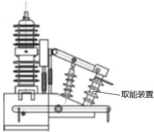
注意：1. 将取能装置取出三只，分别按线间距通过下法兰固定螺丝固定于金属横梁架上。在金属横梁架上留取能装置出线孔，并将取能装置电源引出线从出线孔穿出。
